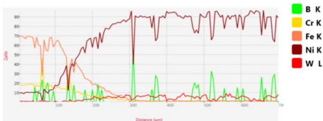
Рис. 3. Результаты ЭДС анализа распределения химических элементов в поперечном сечении КМ № 1 после ВП и ТО
