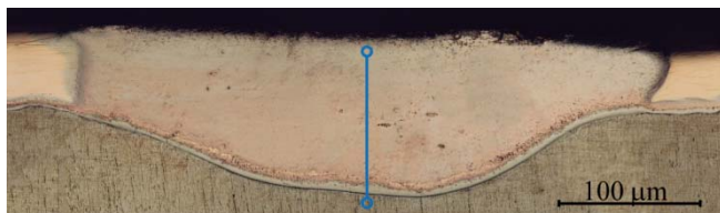
Рис. 3. Структура зоны переплава с распределением химических элементов в центральной ее части после лазерной обработки ( \delta = 0,4 мм, V = 0,8 м/мин)
